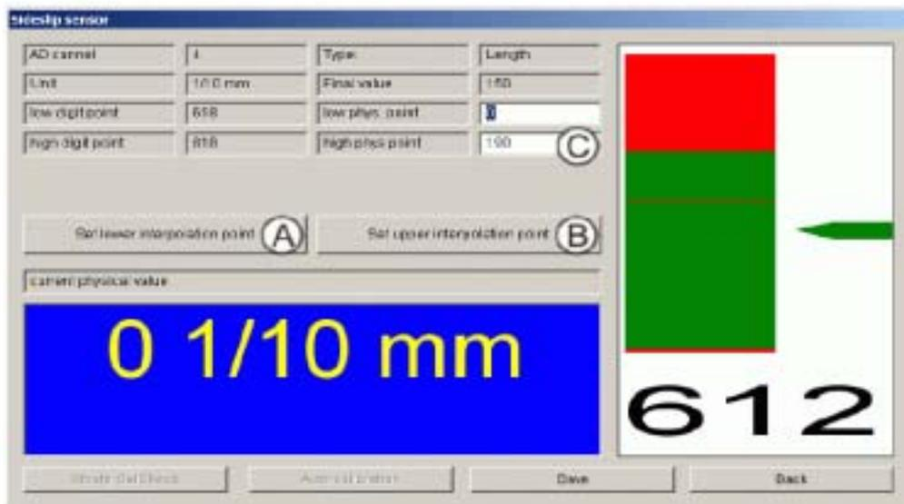
想办法把侧滑板的偏移量稳定下来，例如可以用硬物卡在侧滑板和边框之间。然后仔细测量出偏移后的侧滑板和边框之间的距离，两次的测量值之差就是侧滑板的真实偏移量。
