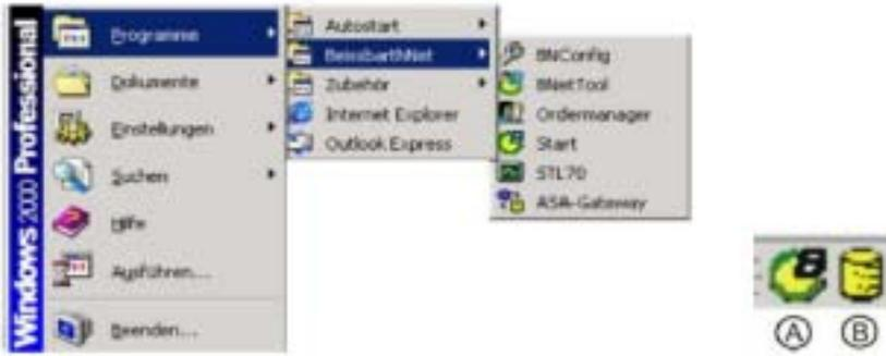
重新启动计算机。检查整个系统的所以联系是否正前无误，电源供应是否正常，网络终端设置是否正确。当确定所有连接都正常之后，打开总开关盒的电源开关。观察模拟显示板的 LCD 显示是否有错误信息显示。如果一切正常，则用鼠标双击计算机桌面上的 BnetTool3 图标，启动 BnetTool 软件。如果模拟显示板的 LCD 显示以下信息，则表明系统存在问题。
