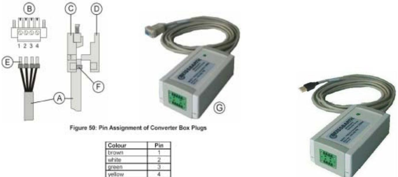
从 B 图所看去的方向来区分，Bnet 信号线的棕线接 1 端，白线接 2 端，绿线接 3 端，黄线接 4 端。NSR-3260USB 接口盒的通讯线为 USB 连线，把 NSR-3260 连接到计算机的 USB 端口。
