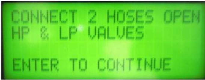
将高低压管路与空调系统连接, 打开高低压快速接头, 打开设备控制面板上的高低压阀门.
