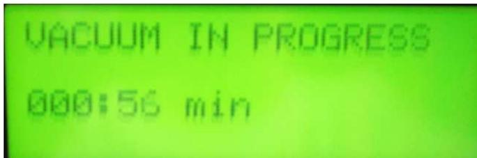
2. 系统抽完真空后,系统自动保压(可以按停止键 40 退出),如果空调系统有泄漏,系统自动提示,有泄漏"LEAKAGE DETECTED",如果空调系统没有泄漏,系统提示"No LEAKAGE DETECTED"
